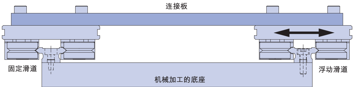
图 3.2 使用定位销时的滑道设置程序。
